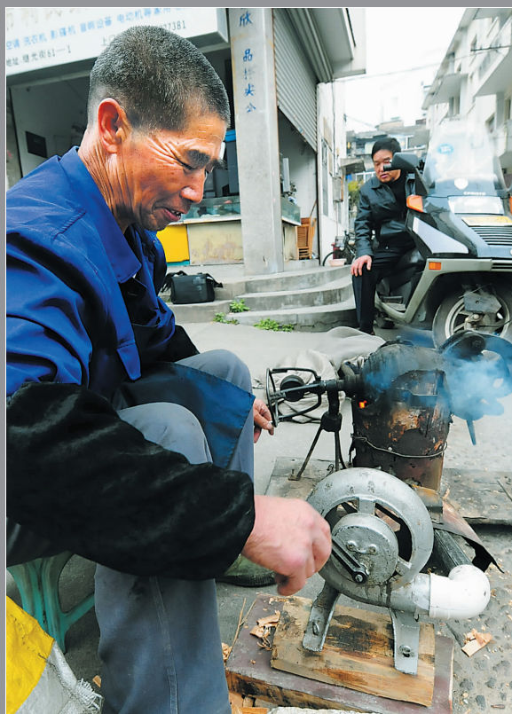
老人一手摇着爆米花机,一手摇着鼓风机炒制爆米花。老人的崩爆米花“设备”都是手摇的。
