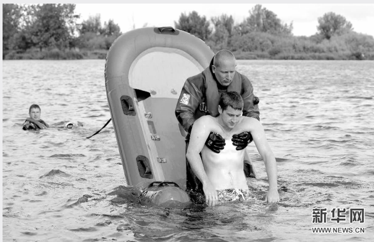
8月9日,在荷兰中部城市祖特梅尔,消防人员测试一种专为营救溺水者而设计的新型水上担架。这种设施可以在水中倾斜,方便救生员将落水者拖出水面。
