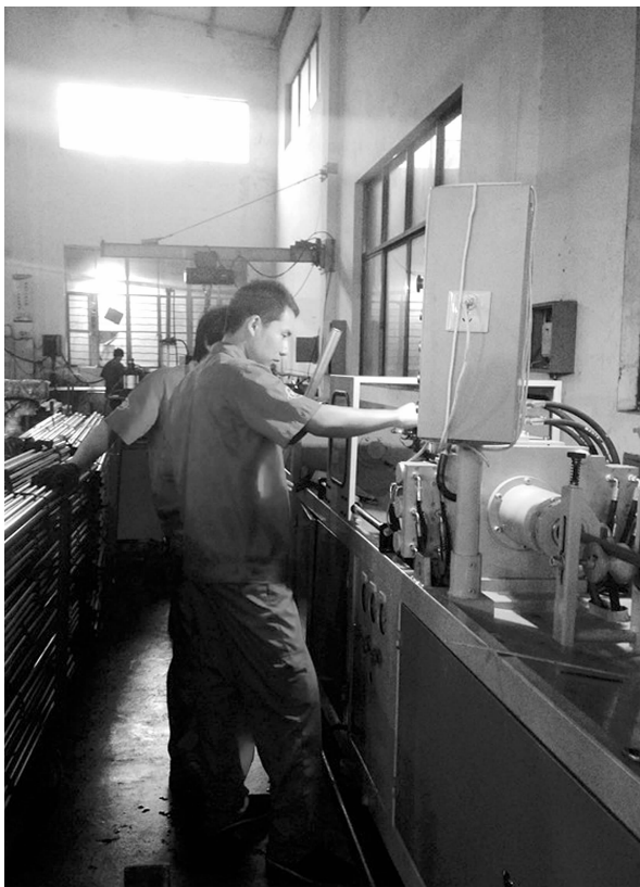
◀“机器换人”热浪汹涌，为我市不少企业“换”出了效益，“换”来了安全和产品品质的全面提升。临海伟达汽车有限公司在“机器换人”的热潮中抢占“风口”，新投入的韩国进口机器使原本需要15道工序才能完成的波纹管加工实现一次性加工完成，缩短了产品的制造工艺链，效率大大提升。当前企业在建的新项目已经进入实质阶段，一期1亿元的投资正逐步到位，86亩大的新厂区将于2016年建成投产，届时能达到5亿元的产能。图为技术人员正调试新设备。 宋金燕摄
